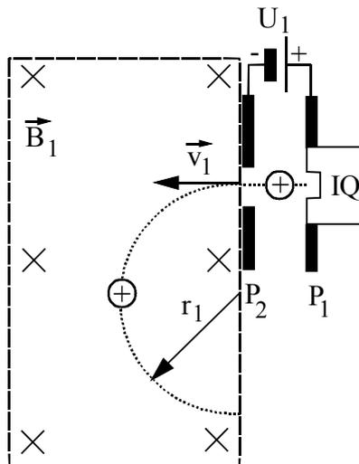
Die Ionenquelle IQ sendet Protonen (Masse  $m_p$ , Ladung  $Q = +e$ ) mit vernachlässigbarer Anfangsgeschwindigkeit aus. Diese Protonen werden im elektrischen Feld zwischen den Platten  $P_1$  und  $P_2$  eines Kondensators beschleunigt. Nach dem Durchlaufen der Beschleunigungsspannung  $U_1 = 18,0$  kV dringen die Protonen mit der Geschwindigkeit  $\vec{v}_1$  in das zeitlich konstante, homogene Magnetfeld der Flussdichte  $\vec{B}_1$  ein.
