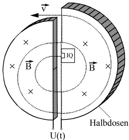
Die Anordnung besteht im Wesentlichen aus zwei flachen Halbdosen. Die beiden halbkreisförmigen Metalldosen werden an die sinusförmige Wechselspannung  $U(t) = 18,0 \text{ kV} \cdot \sin(2 \cdot \pi \cdot f \cdot t)$  angeschlossen.
