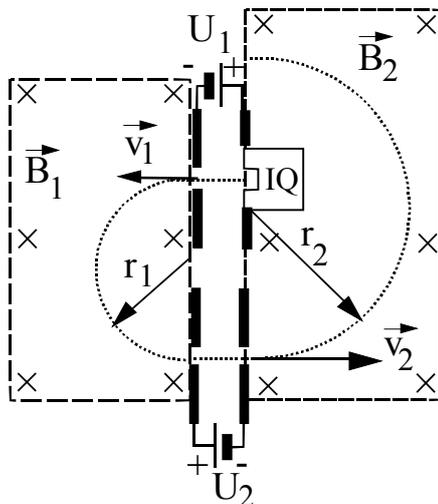
Mit dem Verlassen des Magnetfeldes der Flussdichte  $\vec{B}_1$  tritt das Proton in das elektrische Feld der Spannung  $U_2 = 18,0$  kV ein. Die Spannungsquelle ist so gepolt, dass das Proton erneut beschleunigt wird.
